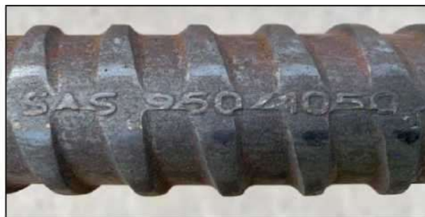
Figura 121: Dywidag WR - Dettagli identificativi (Barra Dywidag Classe 950/1050)
