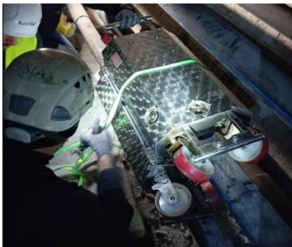
Figura 118: Esempio di Prova magnetoaduttiva
