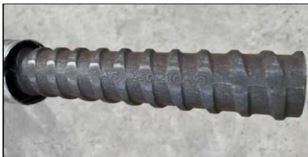
Figura 121: Dywidag WR - Dettagli identificativi (Barra Dywidag Classe 950/1050)
