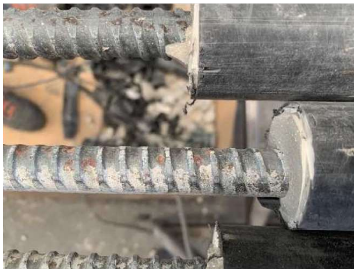
Figura 134: Barra con guaina preiniettata con boiaccia di cemento
