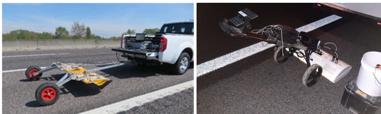
Figura 10 –Determinazione spessore pavimentazione stradale da piattaforma stradale con georadar multicanale
