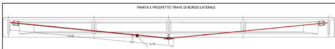
Figura 100: Esempio di rilievo del Sistema di Precompressione Esterna (Rinforzo e Supporto)
