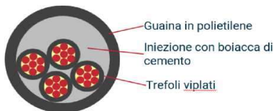
Figura 137: Sezione di cavo costituito da trefoli viplati
