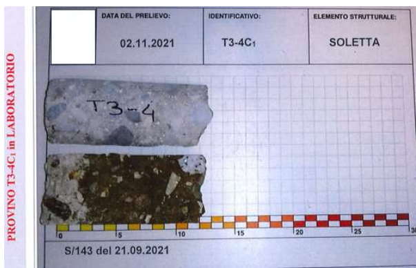
Figura 55 – Esempio di restituzione dati – Profondità di penetrazione di ioni cloruro metodo colorimetrico
