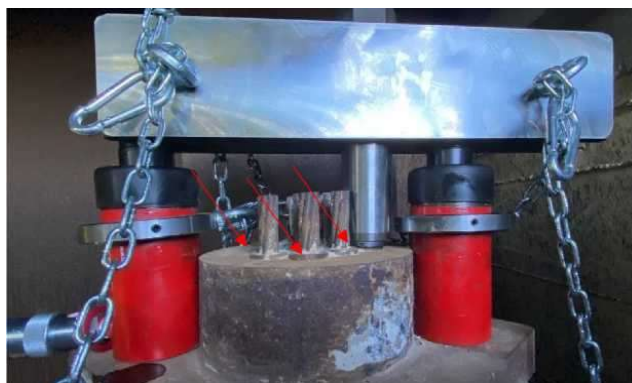
Figura 107: Esempi di punti da attenzionare - cunei di bloccaggio alla testata per multi-trefolo
