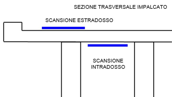
Figura 39 - Rilievi principali delle barre di armatura delle solette e sbalzi
