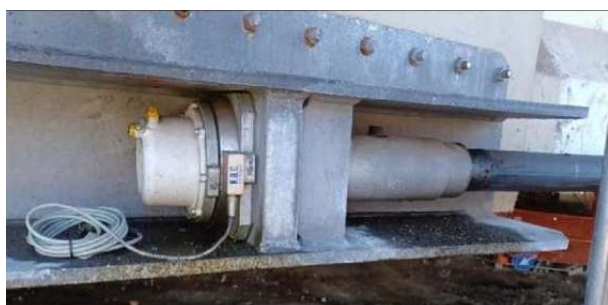
Dettaglio "cella di carico" installata su testata di precompressione esterna
