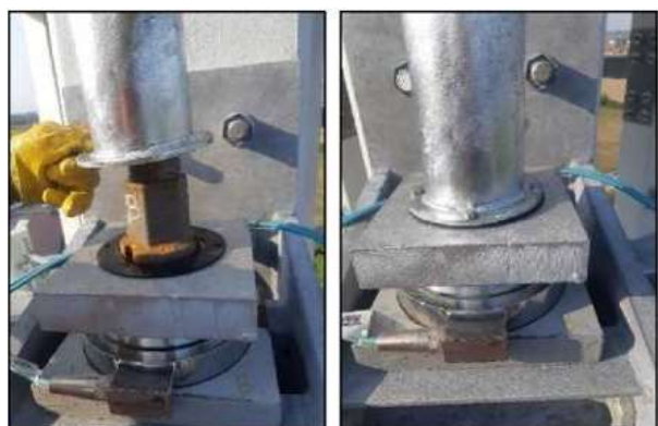
Dettaglio ancoraggio barre Dywidag diametro 40 mm con cella di carico
