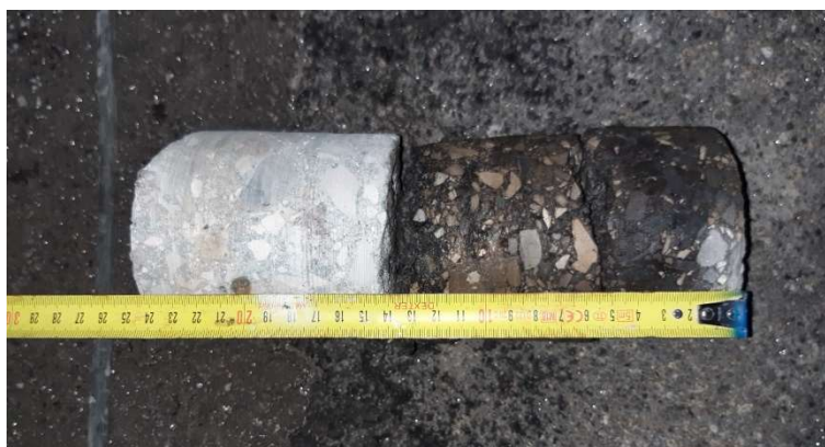
Figura 9 – Esempio di restituzione – Prelievo di carota da pavimentazione stradale
