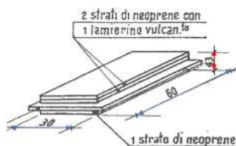
Figura 20-8- Appoggio in neoprene con superficie di acciaio grafitata
