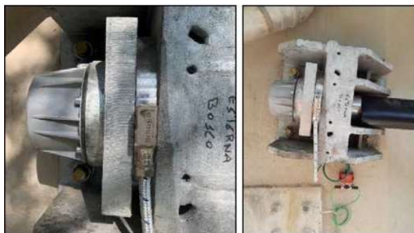
Dettaglio "cella di carico" installata su testata di precompressione esterna
