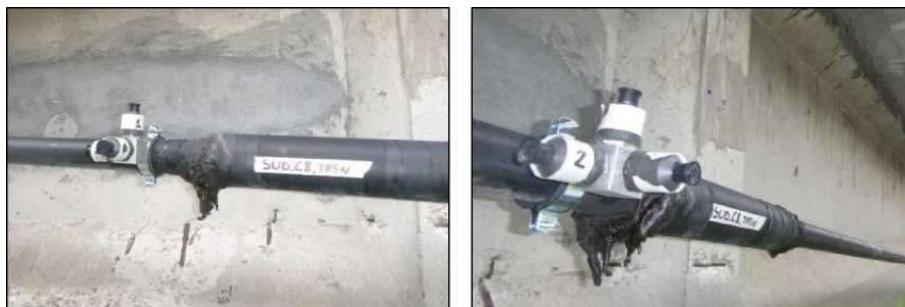
Figura 115: Esempio di posizionamento accelerometri sulla guaina
