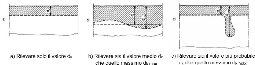
Figura 53 - Schema misura carbonatazione
