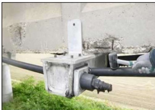
Figura 117: Esempio di applicazione della forzante impulsiva - Hammer Test
