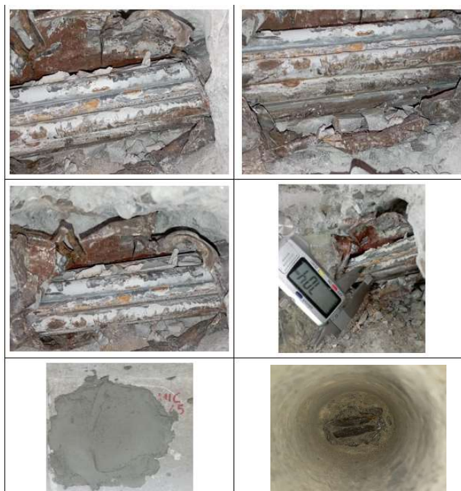
Figura 81 – Esempio scheda di restituzione – Saggio visivo eseguito su prova endoscopica e tomografica con georadar di riferimento
