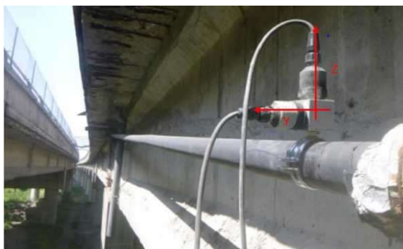
Figura 114: Esempio di posizionamento accelerometri sul cavo
