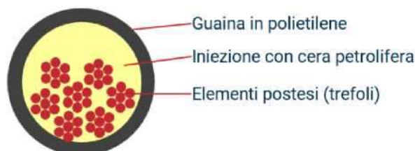
Figura 135: Sezione con iniezione con cera eseguita dopo la tesatura
