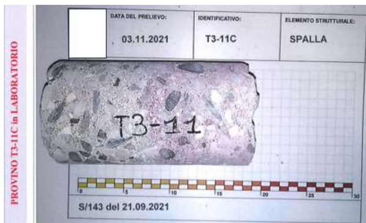
Figura 54 – Esempi di restituzione – Misure della profondità di carbonatazione
