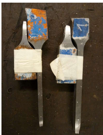
Figura 59 – Esempio di restituzione dati – Prove di trazione su carpenteria metallica
