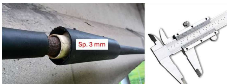
Figura 102: Esempio di Rilievo spessore guaina
