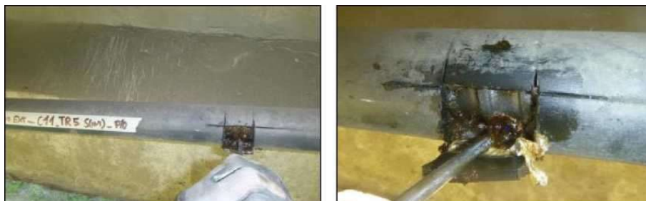
Figura 116: Esempio di posizionamento accelerometri sull'armatura previa apertura della guaina
