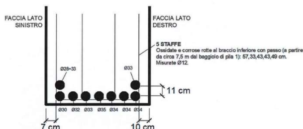
Figura 19 - Esempio di restituzione con ubicazione e ricostruzione del profilo/sezione dell'elemento
