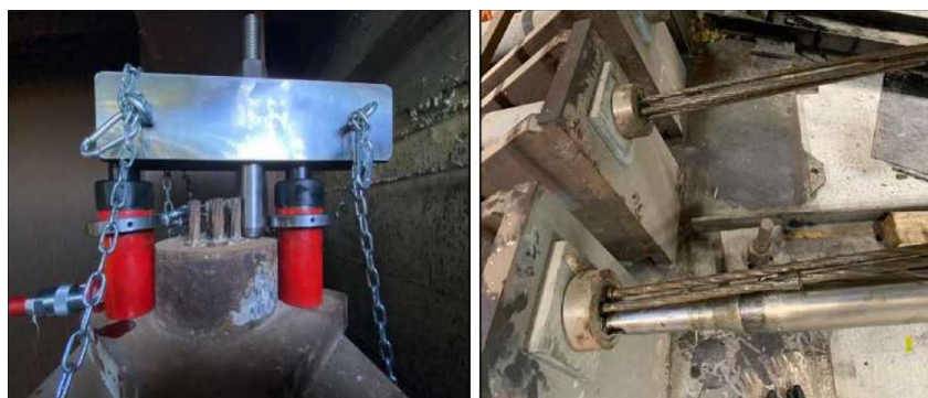
Figura 105: Esempio di prova di stacco con martinetti
