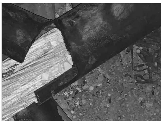
Figura 133: Cavo e Sezione con iniezione con boiaccia di cemento eseguita dopo la tesatura
